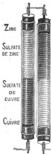
FIG. 34. — Pile humide montée en colonne, système de M. Gustave Trouvé.
