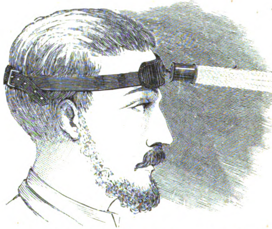
Fig. 83. — Photophore électrique frontal du docteur Hélot et de M. Gustave Trouvé.
