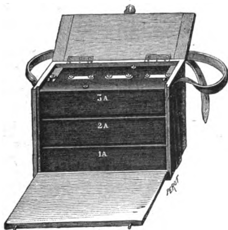
FIG. 227. Pile militaire de M. G. Trouvé. Une batterie semblable est placée sur le sac-bobine.
