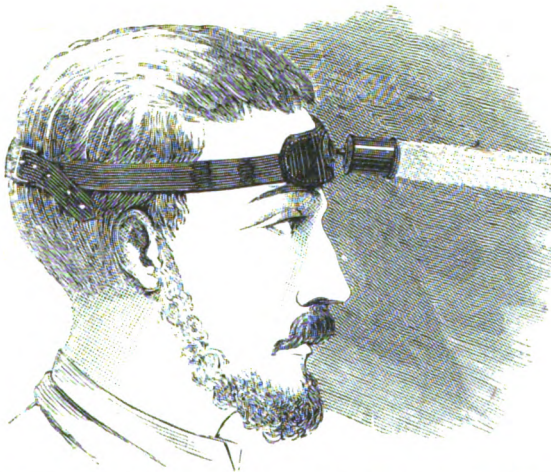
FIG. 197. — Photophore électrique frontal de MM. le Dr Hélot et Trouvé. Premier modèle.
