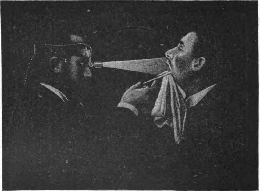
FIG. 219. — Photophore électrique frontal de MM. le Dr Hélot et Gustave Trouvé. Dernier modèle. Il est employé comme laryngoscope.
