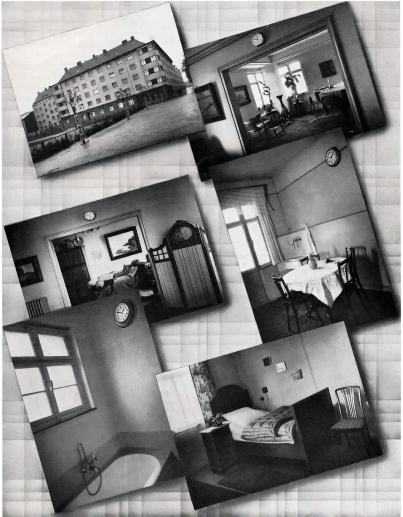
Abb. 19 bis 24. Der Siedlungsblock Krefelderwall des Erbbau-Vereins Köln e. G. m. b. H. verfügt über eine ausgedehnte Uhren- und Weckanlage. Im einzelnen besteht die Anlage aus 2 Normalzeit-Hauptuhren mit 99 Nebenuhren, 1 Weckzentrale mit 98 Stöpselplatten und 98 Summern.
