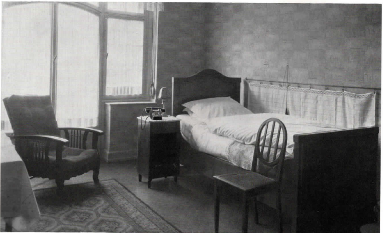
Abb. 16. Krankenzimmer mit Fuld-Fernsprechapparat im West-Sanatorium Köln am Rhein. Die Fernsprechanlage im West-Sanatorium besteht aus einer Fuld-Glühlampenzentrale für 2 Amtsleitungen und 20 Nebenstellen sowie aus 15 Fernsprechapparaten.
