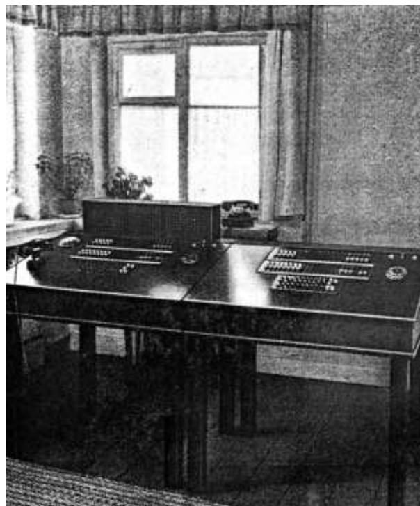
Bedienungspult mit Abfrage- und Vermittlungstasten zur Fallwähler Universalzentrale 20/200/20 200 teiligem Wähler mit Aushilfsfeld
