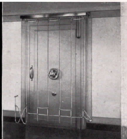
DER TRESOR-SICHERUNGS-PENDEL RUFT BEI JEDEM EINBRUCHS-VERSUCH SELBSTTÄTIG DAS ÜBERFALLKOMMANDO HERBEI
