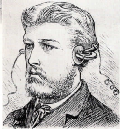
Abb. 135 Die Kopfbügel waren noch etwas primitiv und hatten Hörer mit freistehenden Magneten.
