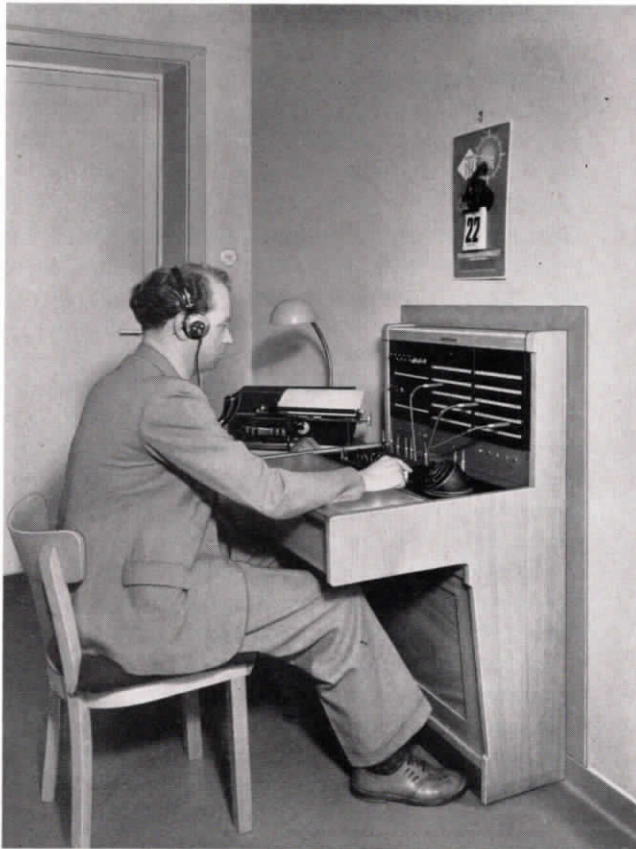
Abb. 1 Schnurzentrale für Blindenbedienung in einem Landratsamt
