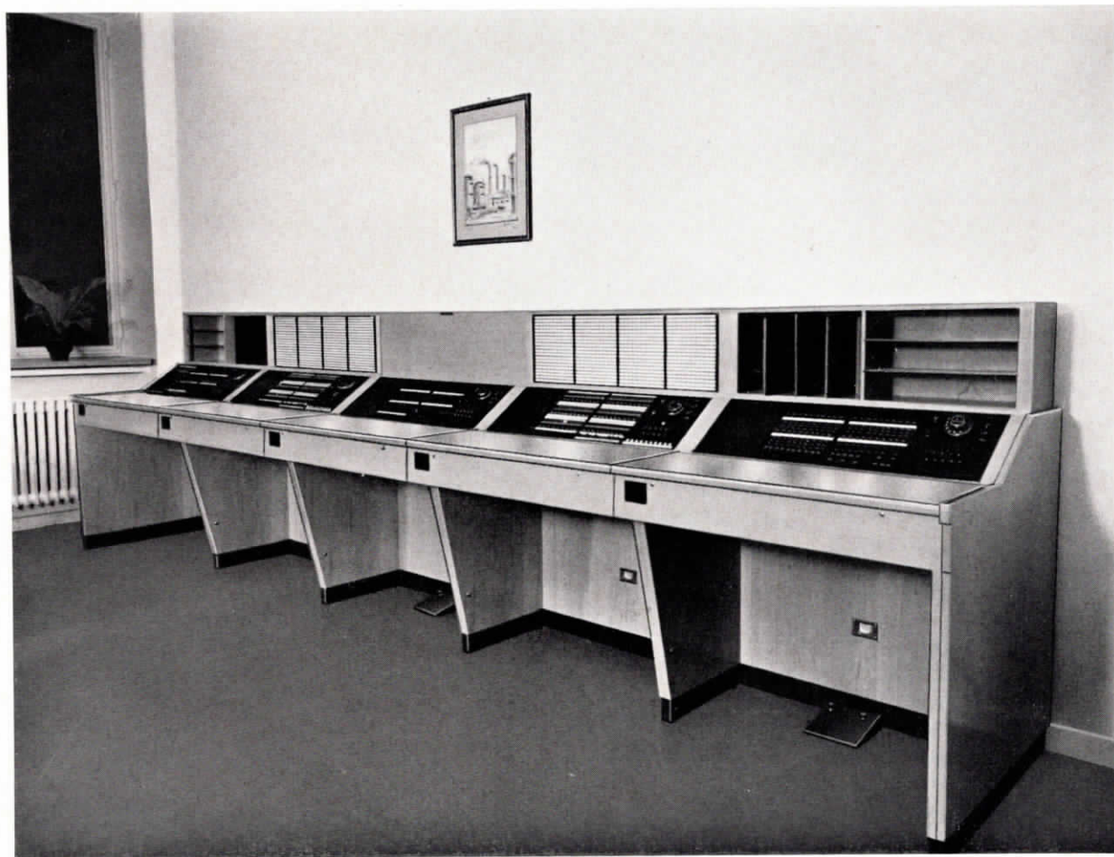
Abb. 4 Vermittlungsplätze mit Zahlengebern und Besetztlampentablos: zwei normale Arbeitsplätze mit Besetztlampenfeldern und drei Arbeitsplätze für Blindenbedienung
