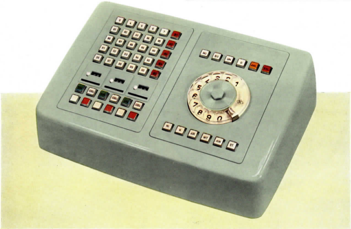
BILD 2 Neuer Vermittlungsapparat der Leuchttasten-Universalzentrale Baustufe II B/C
