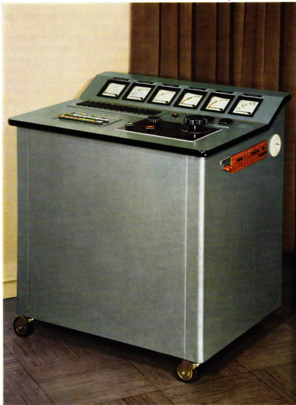
BILD 1 Gerät für die automatische Prüfung von Netz- speisegeräten
