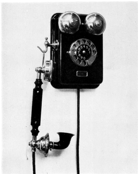
Fig. 86. Vägapparat använd för lokala automatväxlar av L. M. Ericssons typ OL vid Stockholm C och Hagalund Ö. Apparatmodellen tillkom 1922.
